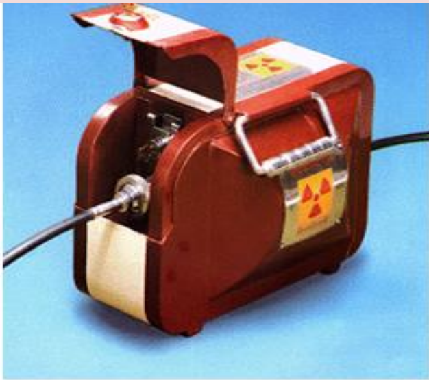
กล้องถ่ายภาพด้วยรังสีใช้ต้นกำเนิดรังสี Ir-192
