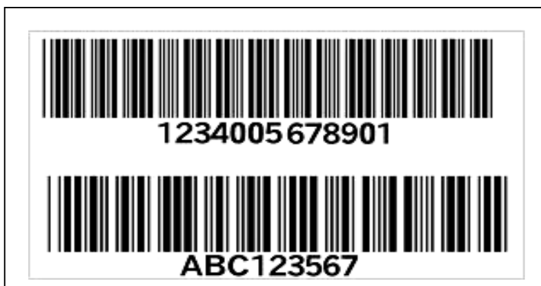
ภาพที่ 10.7 รหัสการทำงานของ บาร์โค้ด (Barcode) หรือรหัสแท่ง ของระบบ EAN-13 ที่มา : สำนักงานส่งเสริมการศึกษานอกระบบและการศึกษาตามอัธยาศัย (2558 : 61)
