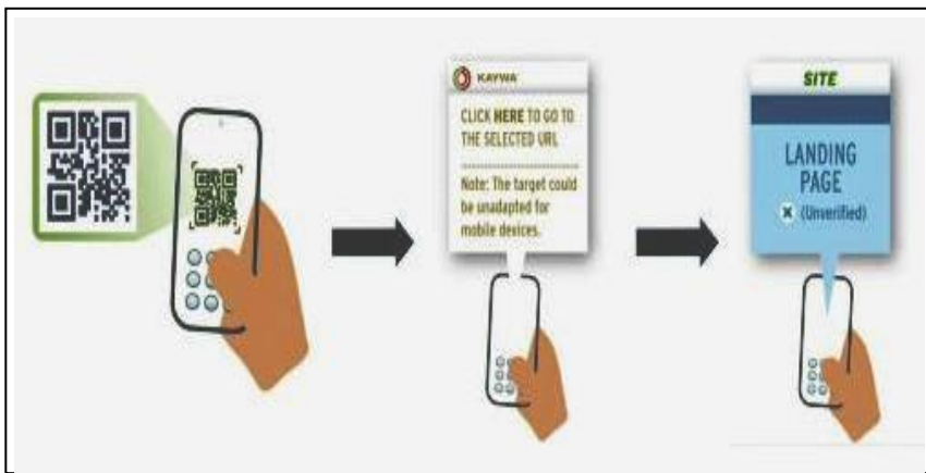
ภาพที่ 10.9 กระบวนการทำงานของการสแกนคิวอาร์โค้ด (QR code) กับสมาร์ทโฟน (Smart phone) ที่มา : บุขรา ประกอบธรรม (2558 : 81)
