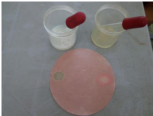
กระดาษลิตมัสน้ำดอกเข็มใช้ทดสอบความเป็นเบส
