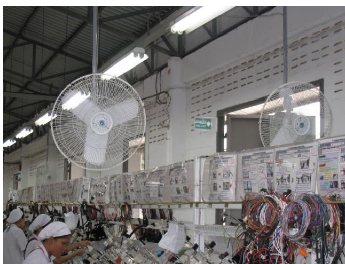
ภาพที่ 27 การปรับปรุงในส่วนโรงผลิตโดยการติดตั้งพัดลมเพื่อระบายอากาศ
