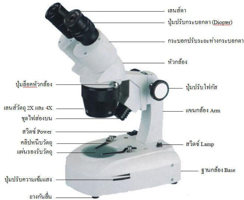
ภาพ 9 ส่วนประกอบของกล้องจุลทรรศน์ใช้แสงแบบสเตอริโอ
