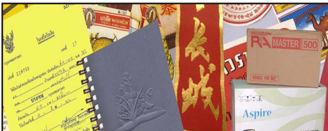
ภาพที่ 7.3 ตัวอย่างสิ่งพิมพ์ที่พิมพ์ด้วยระบบเลตเตอร์เพรส เช่น การดุนฐน พิมพ์กล่อง การเจาะรู การเดินทอง ฉลากสินค้า การแสดงตัวเลขในใบเสร็จรับเงิน และเทคนิคพิเศษต่างๆ
