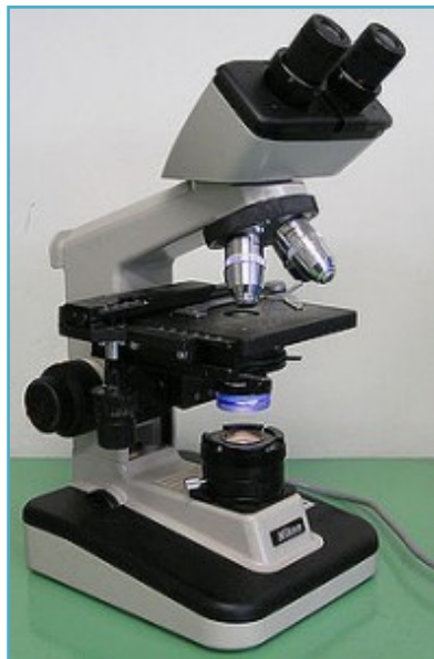
ภาพประกอบ 2-1 กล้องจุลทรรศน์แบบใช้แสง (ที่มา : en.wikipedia.org/wiki/Microscope )
