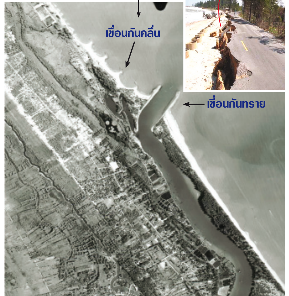
ภาพที่ 16 การเสียสมดุลของหาดทรายเนื่องจากเขื่อนกันทรายปากคลองนาทับ และเขื่อนกันคลื่น ซึ่งส่งผลให้เกิดการสูญเสียหาดทราย และการกัดเซาะชายฝั่งที่บ้านนาทับ อำเภอเมือง จังหวัดสงขลา
